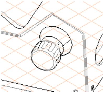
4. Ajuste a espessura do fatiador girando o regulador de espessura (parte 10). Gire o botão do posicionador no sentido horário para limitar a espessura máxima desejada para a fatia. **Atenção:** Pela norma NR12, o regulador de espessura foi limitado a abertura máxima de 5 mm. **Atenção: Não force a abertura superior ao permitido, como risco de danificar o equipamento e de sérios ferimentos.**
