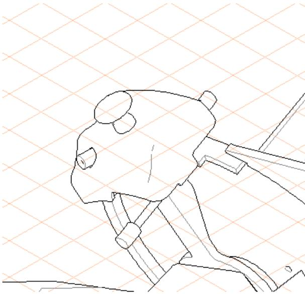
4. Puxe o afiador (parte 4) para cima, gire 180° e coloque-o novamente na posição, alinhando os sensores de segurança. Posicione a pedra do lado direito para baixo colocando a na posição de afiamento.
